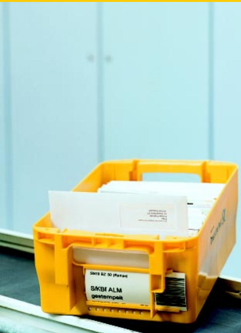
Abb. 1: Standard- und Kompaktbriefsendungen im Behälter der Größe 1; Kennzeichnung an der Frontseite durch Infoträger
